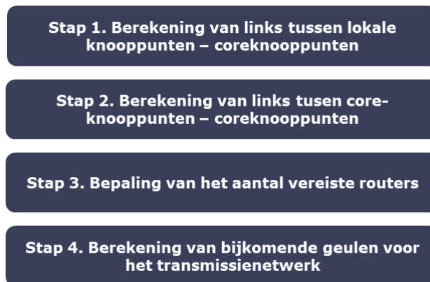
Figuur 6.14: stappen voor de dimensionering van het transmissienetwerk [Bron: Axon Consulting]
