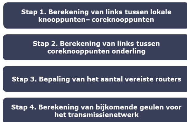
Figuur 6.16: stappen voor de dimensionering van het transmissienetwerk [Bron: Axon Consulting]
