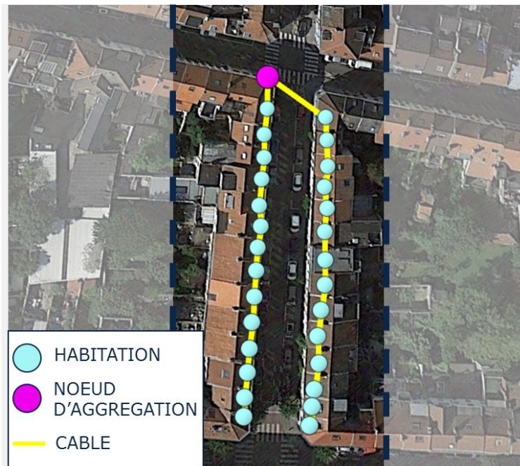
Figure 5.4 : Illustration des résultats de l'algorithme arborescent minimum entre les bâtiments et leur OFP dans un géotype URBAIN [source : Axon Consulting]
