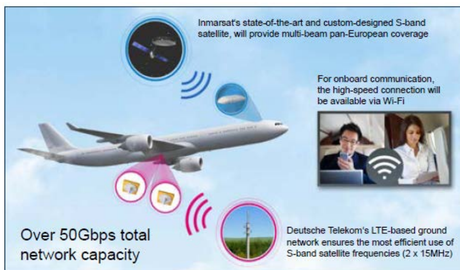
Figure 6 – Différents rôles des terminaux tournés vers le sol et des terminaux de satellite dans l'EAN 26
