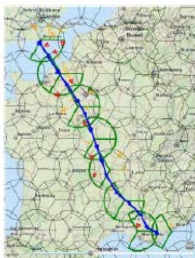
Figure 12 – Description de la couverture contiguë fournie par les stations ATG basées au sol 61
