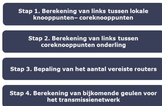
Figuur 7.13: stappen voor de dimensionering van het transmissienetwerk [Bron: Axon Consulting]
